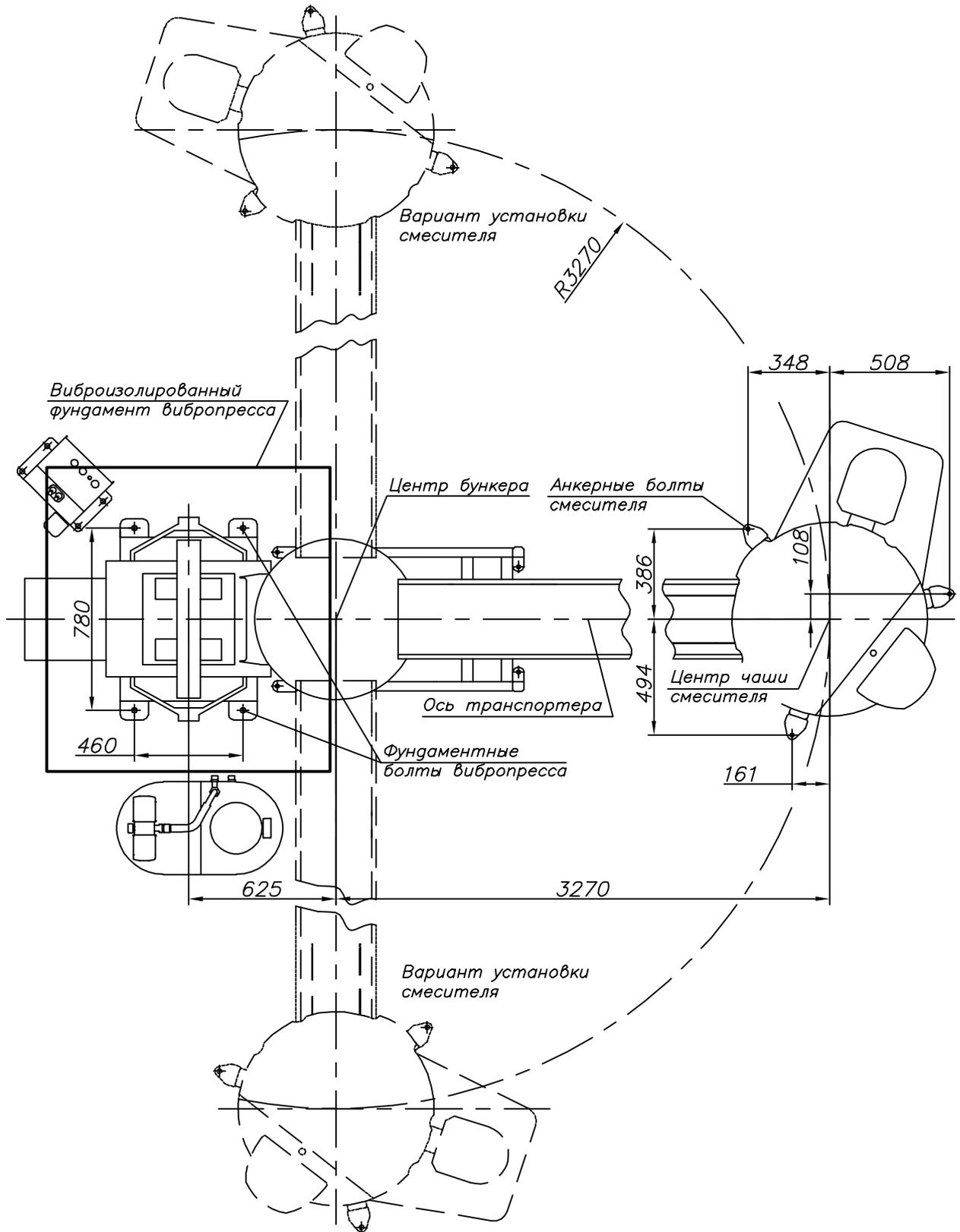
Рис. 15. Схема установки вибропрессов, бункера и смесителя.
