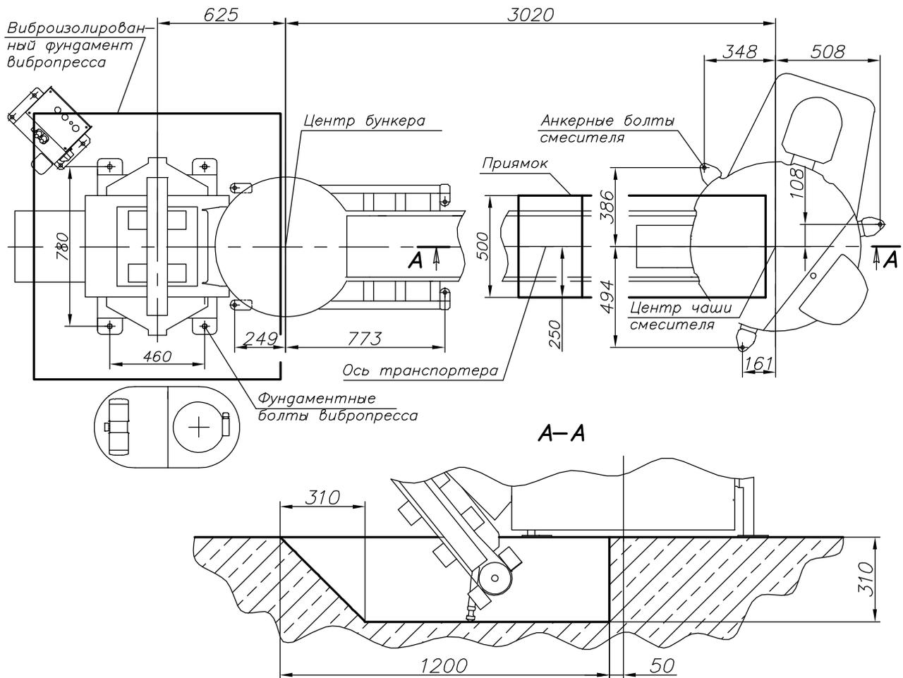
Рис. 16. Схема установки вибропресса, бункера и смесителя при использовании прямока.
