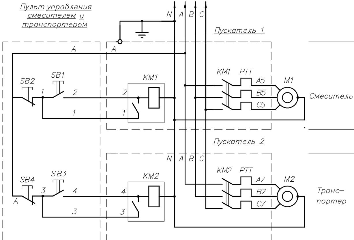
Рис. 13. Схема электрическая принципиальная смесителя и транспортера.
