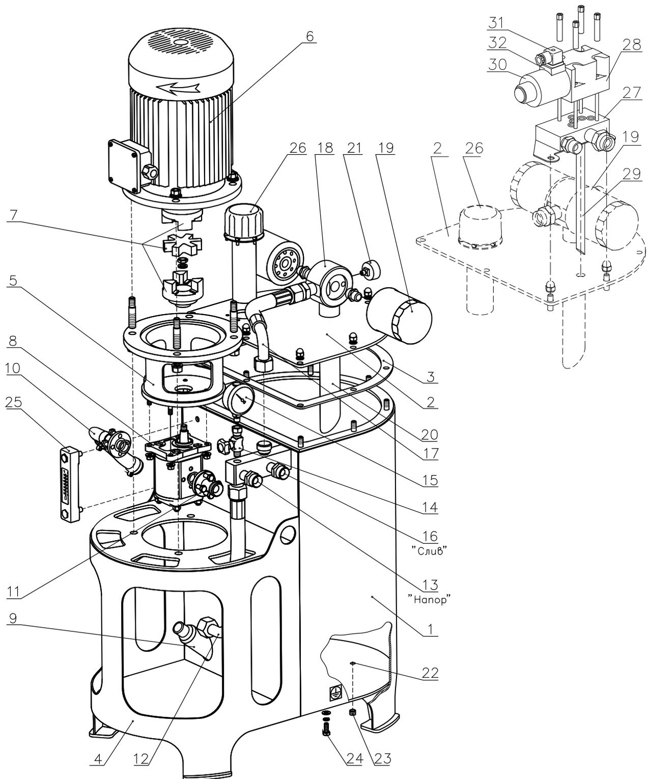
Рис. 5. Установка насосная.
