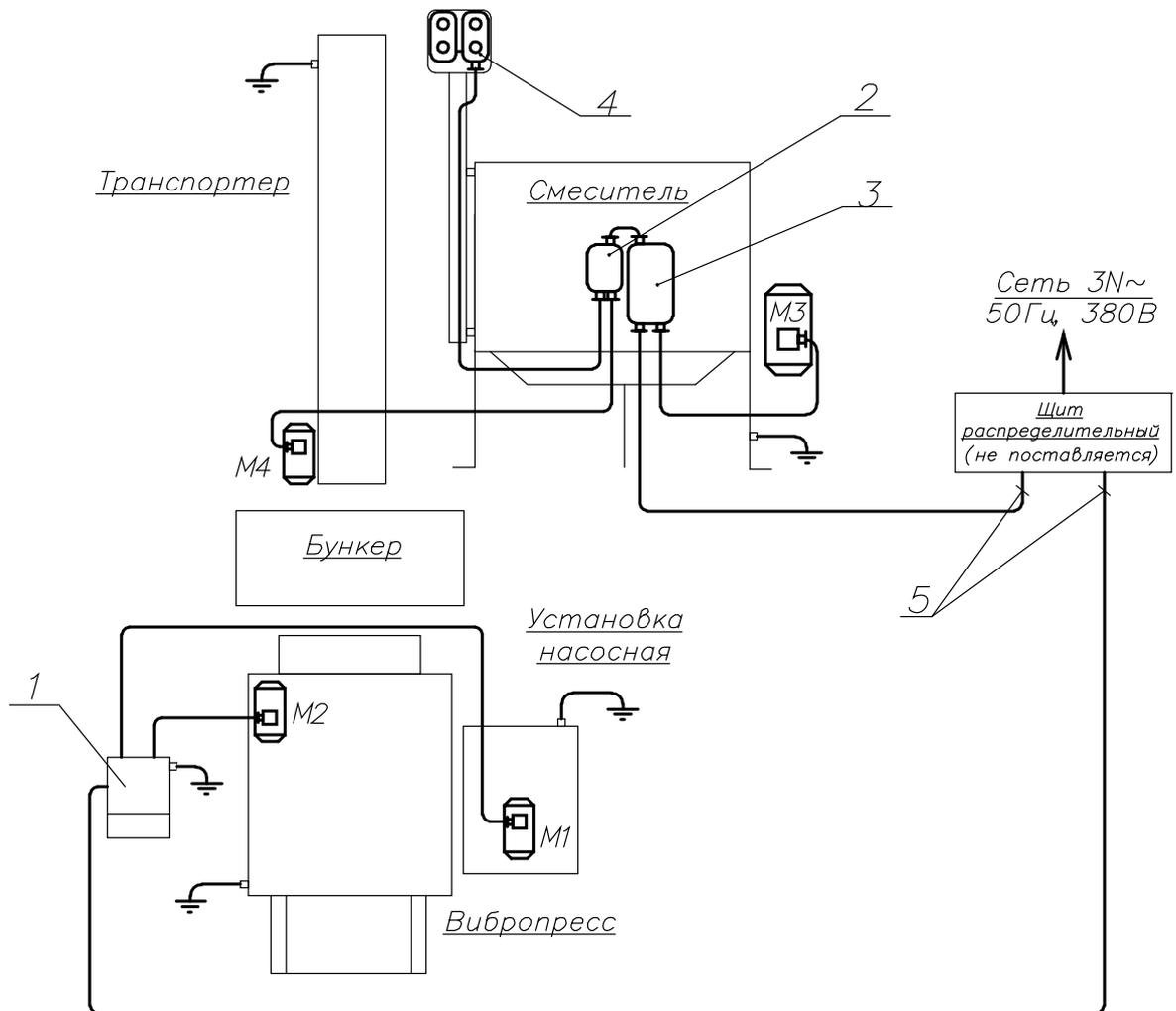
Рис. 14. Схема электрическая подключения.
