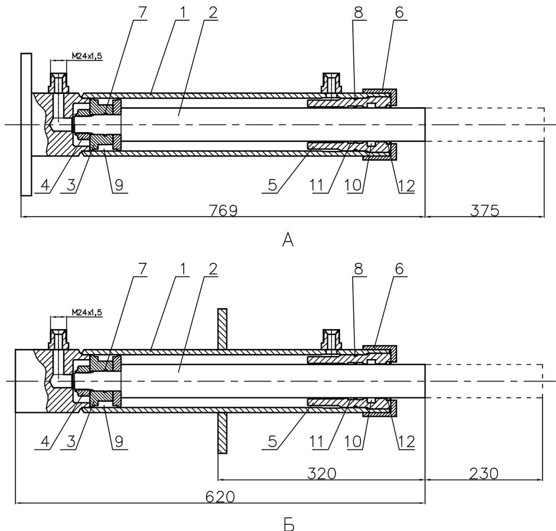
Рис. 7. Гидроцилиндры.
